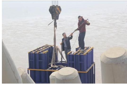
图 31 岸滩站位静力触探测试
