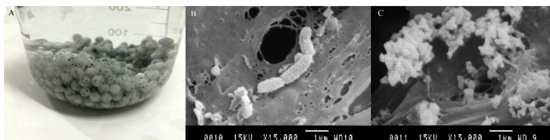
图 25 固定化的硫氧化菌剂 (A) 及载体表面的细菌 (B, C) 电镜照片
